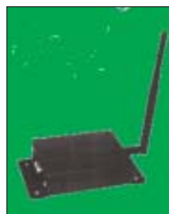
Punto de conexión Wi-Fi: antena emisora de 2,4 GHz conectable a través de un puerto serie
