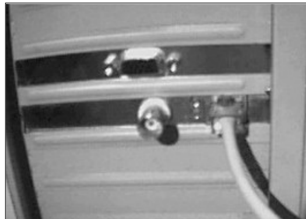
Figura 5. Aunque se monte una red "en bus", las tarjetas de red deben estar preparadas para admitir también conectores RJ-45.
