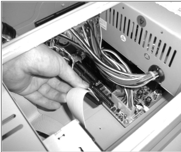
Figura 20. Conectando el bus a la controladora
