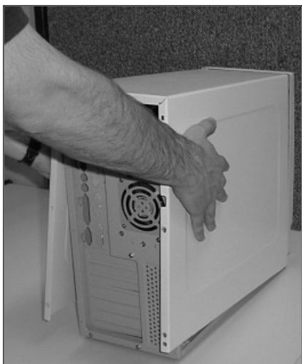
Figura 13. Abriendo la carcasa
