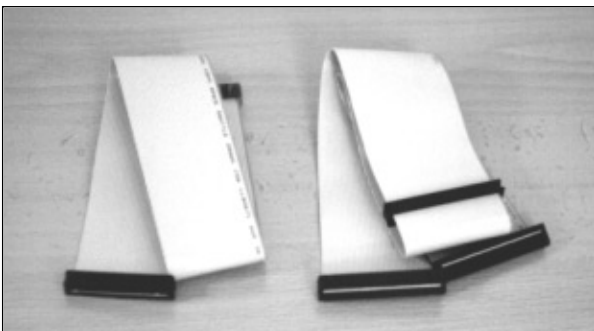
Figura 17. Cintas de los buses de las unidades de disco
