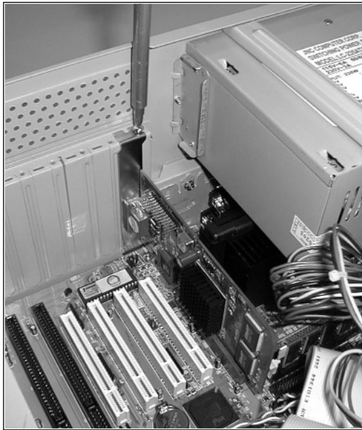
Figura 28. Fijando la tarjeta en su posición
