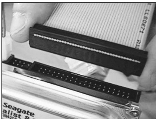
Figura 18. Conectando el bus del disco duro
