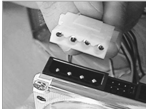
Figura 19. Conectando la alimentación del disco duro
