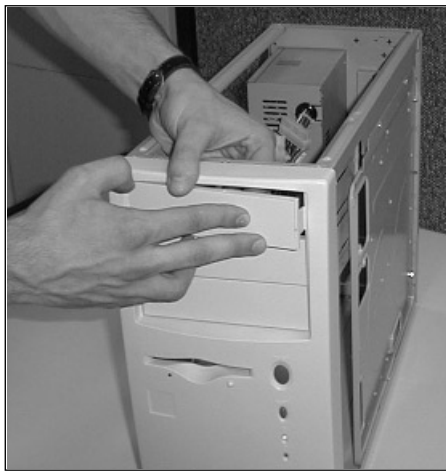
Figura 24. Retirando la tapa del frontal de la carcasa
