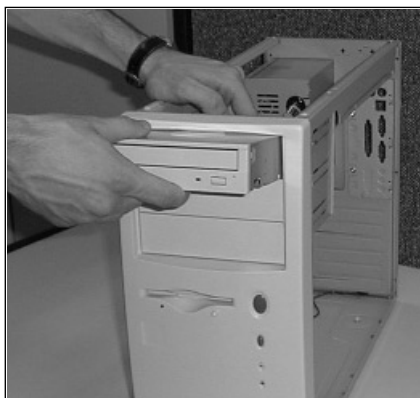
Figura 25. Insertando la unidad de CD-ROM en el chasis
