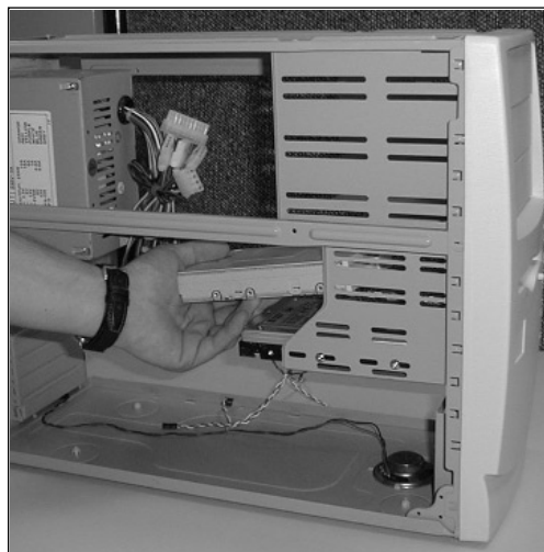
Figura 23. Insertando la unidad de disco flexible
