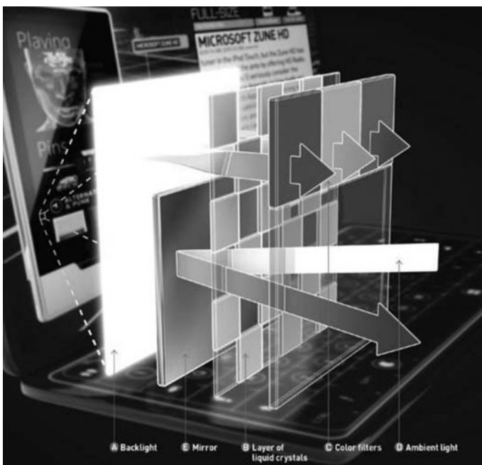
Figura 3. Funcionamiento de la tecnología 3Qi.
