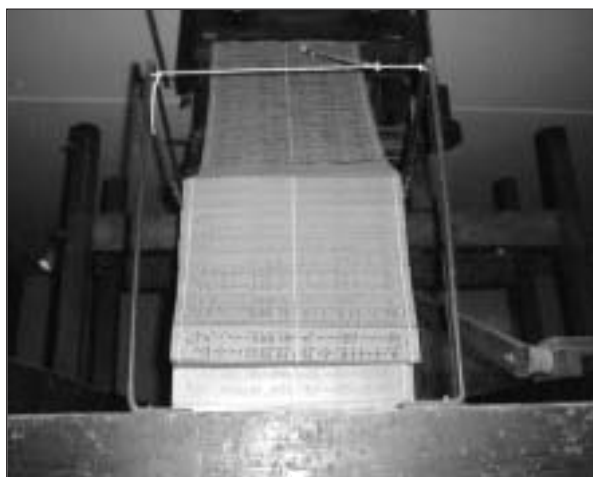
Figura 10. Tarjetas perforadas del telar de Jacquard
