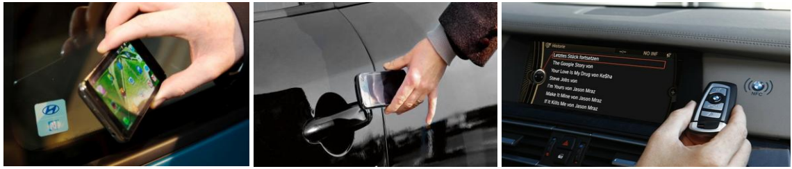
Figura 10. Apertura y arranque del vehículo con NFC
