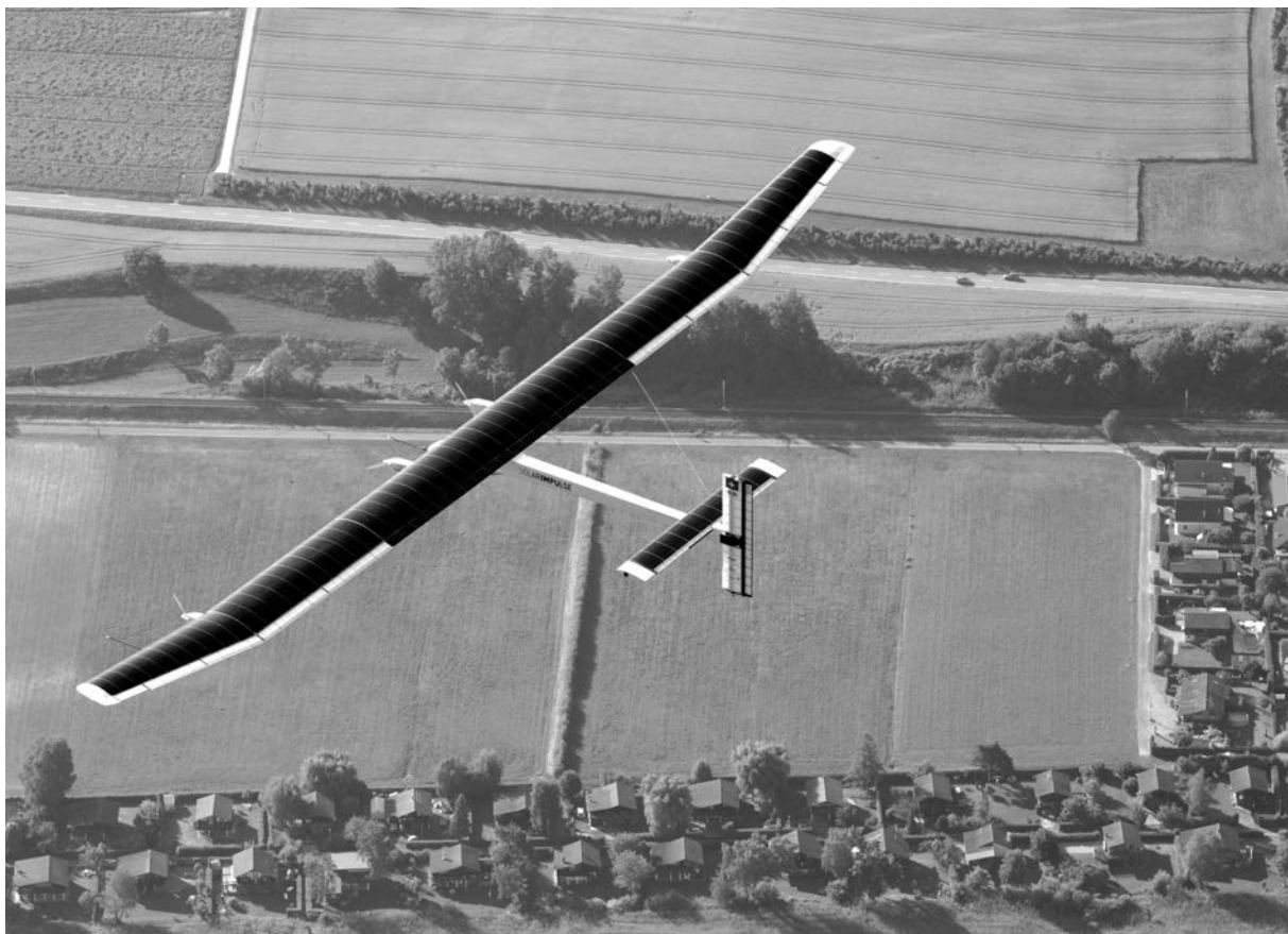
Los cuatro motores de 10 CV de potencia están alimentados con las baterías recargadas durante el día.
