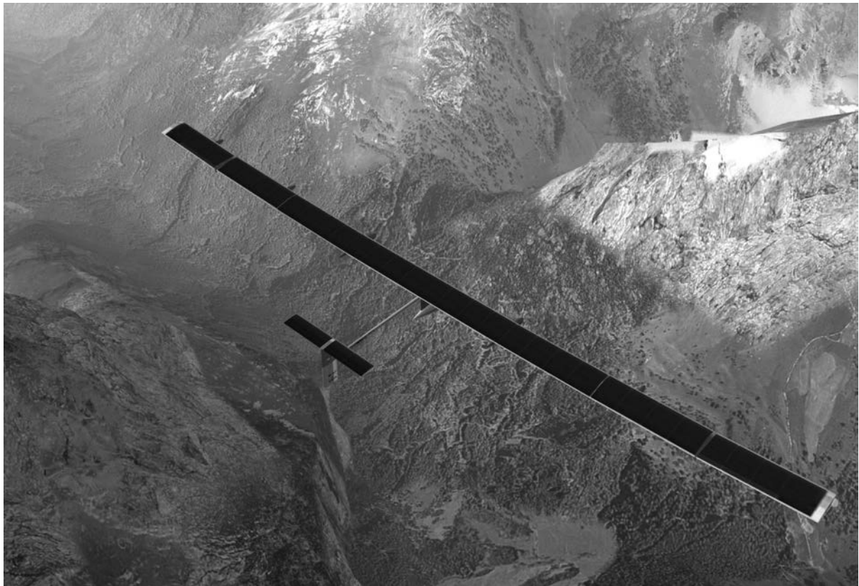
250 m 2 de placas solares proporcionarán el combustible en vuelo.
