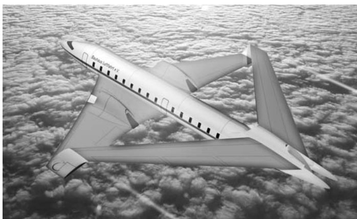
EADS - Hyliner con configuración Boxwing y motores ensamblados, que garantizan una mayor estabilidad y economía de combustible en vuelo.
