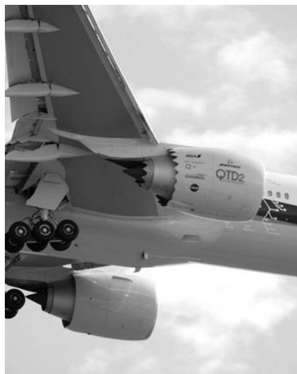
Las ranuras en la tobera del motor del B-787 son el resultado del programa de investigación Quiet llevado a cabo por Boeing.
