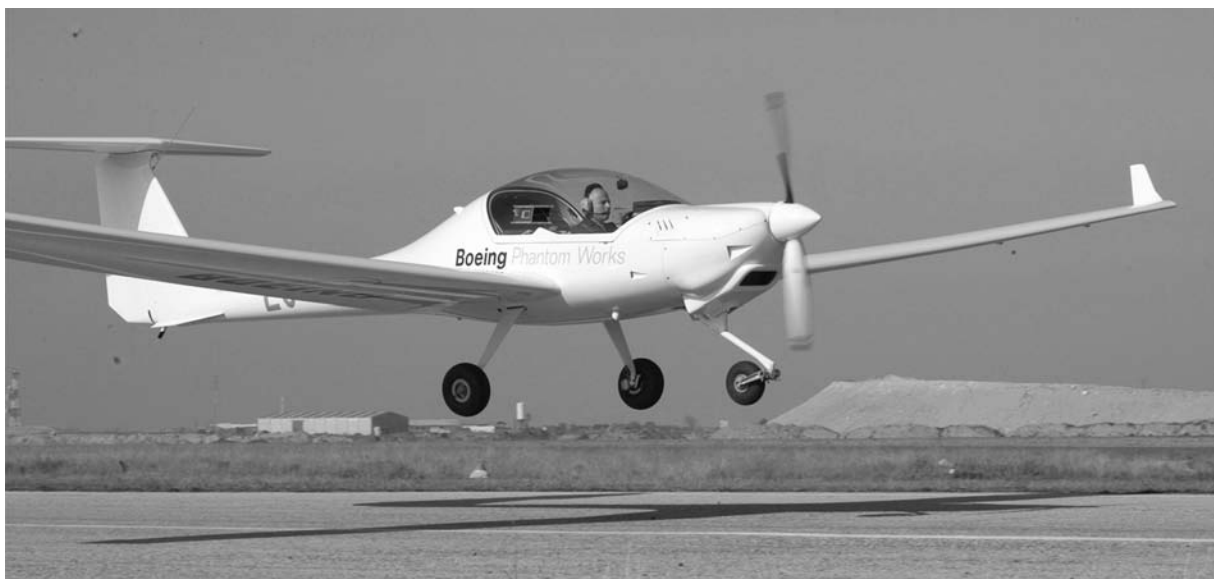
Boeing ha ensayado en Madrid una Diamond propulsada únicamente por medio de pilas de combustible.
